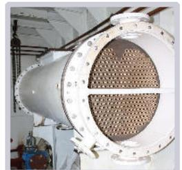
Kondensator mit Anschlüssen
