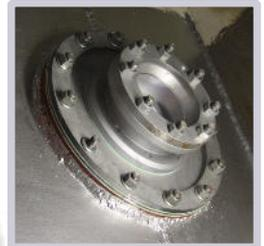
Flansch zur Durchführung der Dampfleitung durchs Schott
